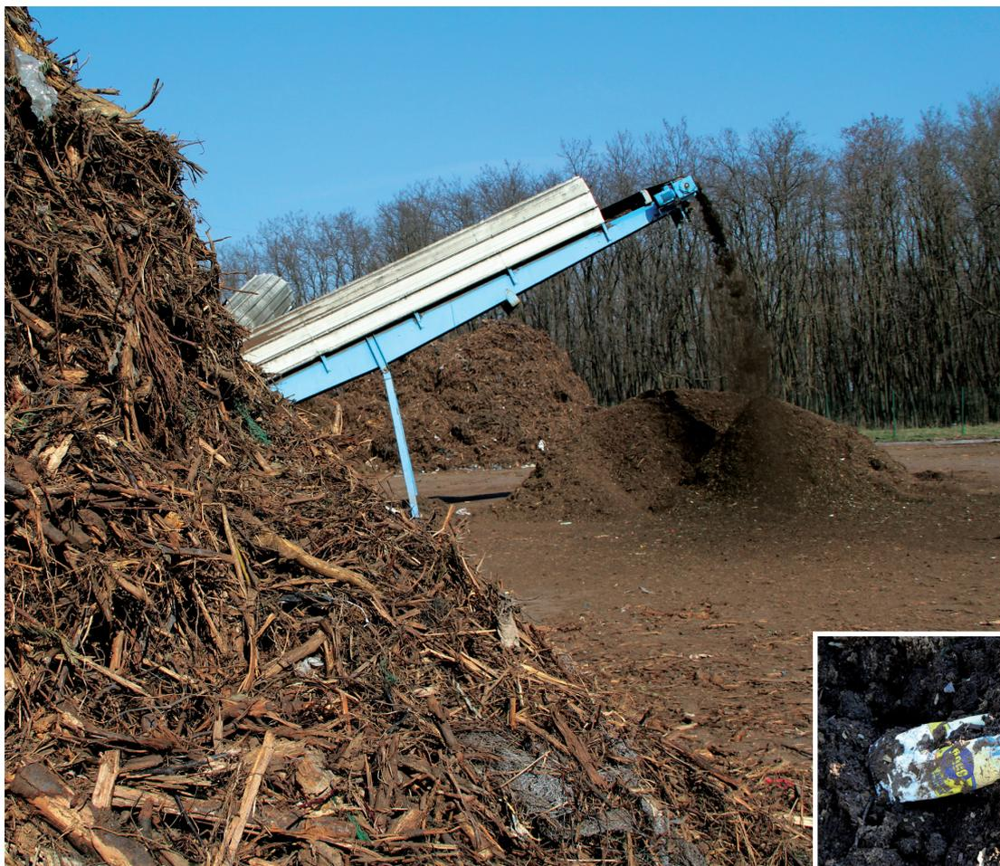
A la sortie de l'usine, le compost tiré des ordures ménagères est mélangé aux déchets verts. Il contient encore des morceaux de plastique qui ont échappé au tri (photo ci-dessous).
